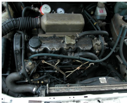
Foto : vierslagdieselmotor in de Opel Kadet
